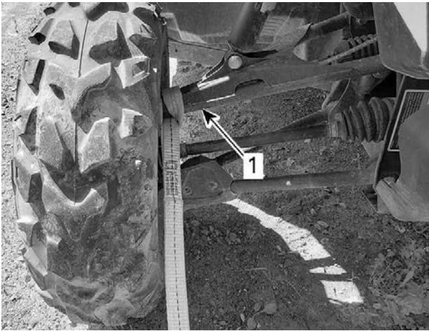
1. Bras de suspension avant supérieur
