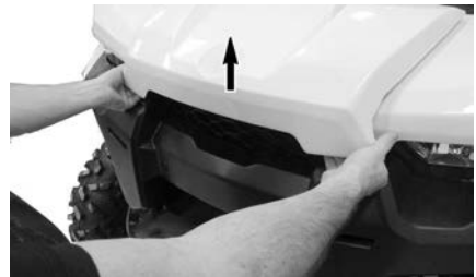
DE RAND VAN HET VOORSTE ONDERHOUDSDEKSEL OPTILLEN.
