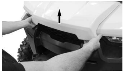
HOCHHEBEN DER WARTUNGSABDECKUNG.
