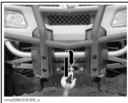
TYPIQUE — EMPLACEMENT DE L'ARRIMAGE AVANT
