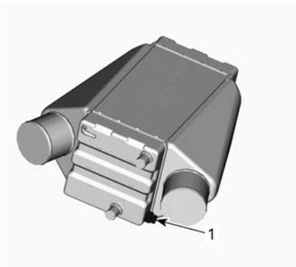
Verifique se há desgaste nos ânodos sacrificiais. Se houver desgaste de mais da metade, substitua o ânodo.
