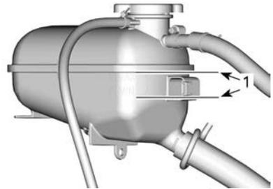
**TANQUE DE EXPANSÃO DO LÍQUIDO DE ARREFECIMENTO**
