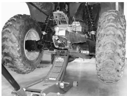
BILDET VISER – LØFTEPUNKT BAK PÅ KJØRETØYET
