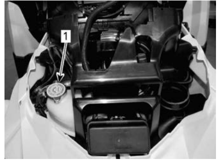
1. Depósito de refrigerante del motor
