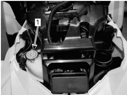
1. Depósito de refrigerante del motor
