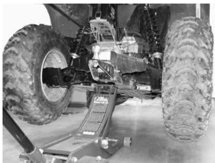
BILDET VISER – LØFTEPUNKT BAK PÅ KJØRETØYET
