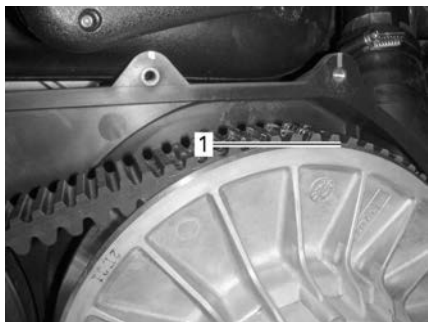
1. 轮齿最低部分与传动皮带的外部表面齐平
