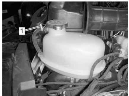
1. Løkk for kjølevæskebeholder
