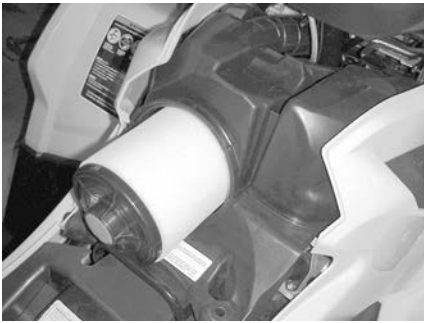
RIMOZIONE DEL FILTRO DELL'ARIA
