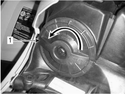
1. Copertura filtro dell'aria
