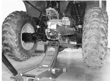
BILDET VISER – LØFTEPUNKT BAK PÅ KJØRETØYET
