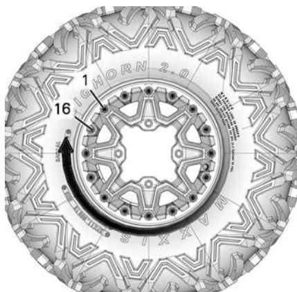
SITUAZIONE TIPICA - SEQUENZA DI SERRAGGIO FINALE
