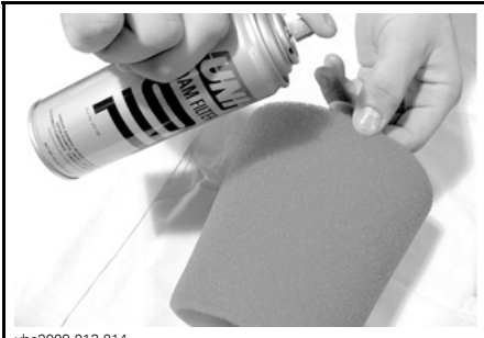
TYPISCH - FILTERELEMENT MET OLIE SMEREN
