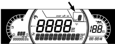
Diese Anzeige zeigt die Getriebestellung des iBR an:
