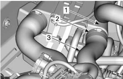
1. Ausrichtungslinien am Schlauch
