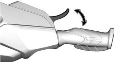
Der Gashebel ist federbelastet und sollte im unbetätigten Zustand in die Ausgangsposition (Leerlauf) zurückkehren.
