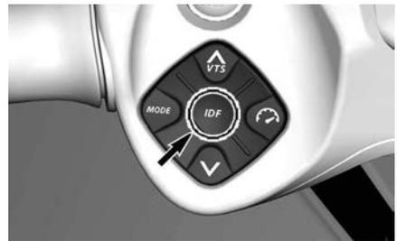
Ermöglicht die Betätigung des iDF--Systems. Siehe Aktivieren des intelligenten verschmutzungsfreien Pumpsystems im Abschnitt Betriebsanleitungen.
