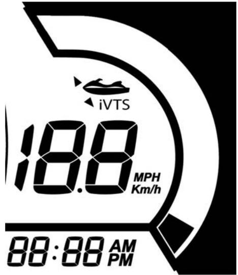
Die Auswahl der mittleren Trimmposition hängt von der aktuellen Trimmposition ab. Doppelklicken Sie auf die VTS-Taste nach OBEN, wenn sie sich unter dem mittleren Trimm befindet, oder doppelklicken Sie auf die VTS-Taste nach UNTEN, wenn sie sich über dem mittleren Trimm befindet.
