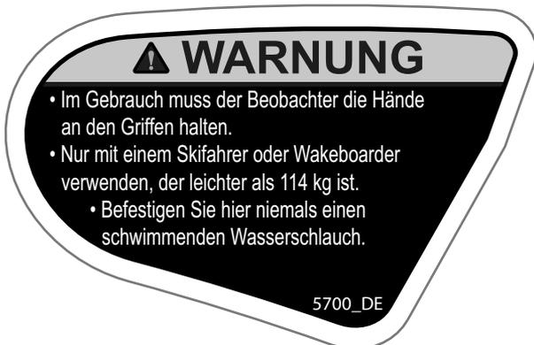
**EINZIEHBARER WASSERSKI-MAST – BEOBACHTER UND GEWICHT – WARNSCHILD**
