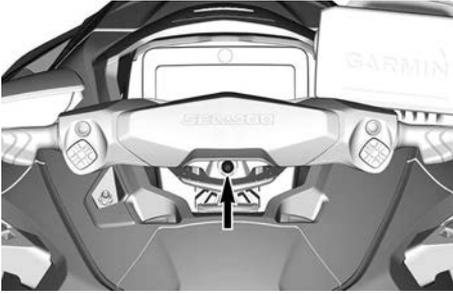
Um den Motor starten zu können, muss die Haltegurtkappe sicher am Motorausshalter befestigt sein.
