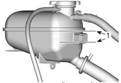
**TANQUE DE EXPANSÃO DO LÍQUIDO DE ARREFECIMENTO**
