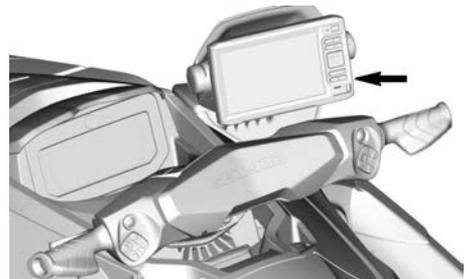
Para remover o sonar, levante a aba e desconecte os conectores elétricos.
