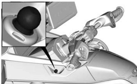
Para permitir a partida do motor, a tampa do cabo de segurança deve estar encaixada firmemente no interruptor de desligamento do motor.
