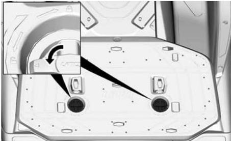
3. Incline a plataforma para frente e puxe para trás para desengatar as abas de convergência.
