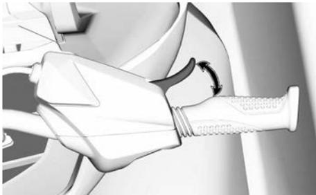
A alavanca do acelerador é acionada por mola e deve voltar à posição de descanso quando não estiver pressionada.
