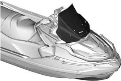
Die Windschutzscheibe ist mit einer Klappe versehen, damit Luft durchströmen kann.
