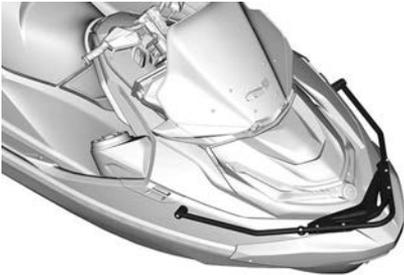
ihren Gummistopperrn einrasten und der Stoßdämpferkopf in die Windschutzscheibenhalterung einrastet
