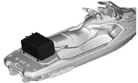
Um den Trockensack vom Fahrzeug zu nehmen, lösen Sie die Bänder und drehen die LinQ-Anker gegen den Uhrzeigersinn.
