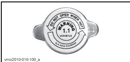
KILPI 11 - SIJAITSEE JÄÄHDYTTIMEN KORKISSA
