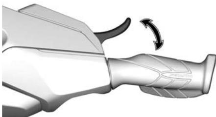
A alavanca do acelerador é acionada por mola e deve voltar à posição de descanso quando não estiver pressionada.
