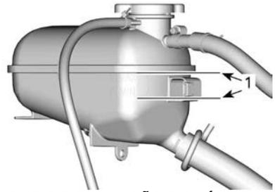
**TANQUE DE EXPANSÃO DO LÍQUIDO DE ARREFECIMENTO**
