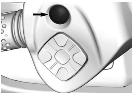
TIPICO - PULSANTE START/STOP MOTORE
