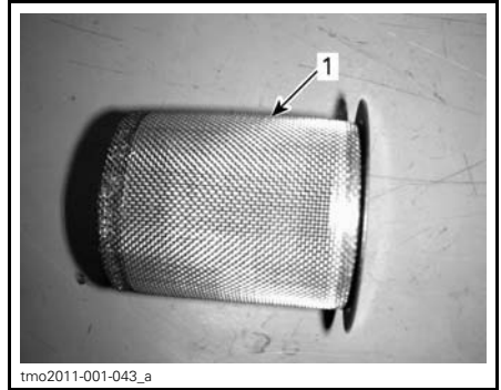
tmo2011-001-043_a 1. Clean spark arrester
