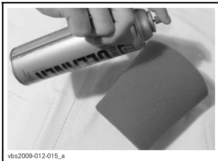
TYPISCH - SCHAUMSTOFFFILTERELEMENT BESPRÜHEN
