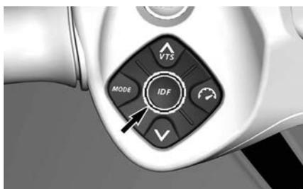
Permite activar el sistema iDF. Consulte *Activación del sistema de bombeo inteligente sin residuos* en la sección *Instrucciones de funcionamiento*.
