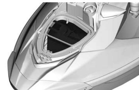
Tire de la pestaña para destrabar y levante la caja para retirarla de la embarcación.
