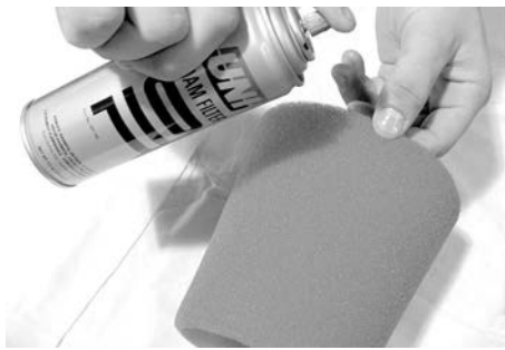
TÍPICA - UNTE O ELEMENTO DE ESPUMA DO FILTRO COM ÓLEO
