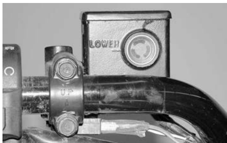
TÍPICO — RESERVATÓRIO DE FLUIDO DO FREIO TRASEIRO ESQUERDO
