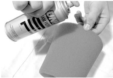
TYPISCH - SCHAUMFILTERELEMENT ÖLEN
