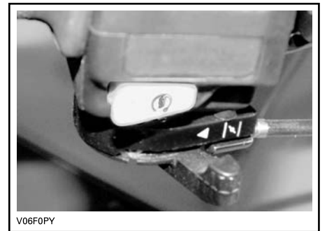
CHOKE GEÖFFNET, HEBEL IN UNBETÄTIGTER STELLUNG
