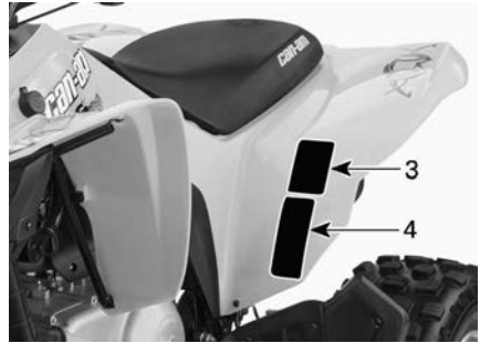
HINWEISSCHILDER AM LINKEN HINTEREN KOTFLÜGEL
