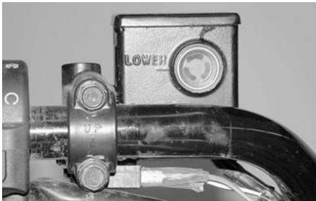
TYPISCH — BEHÄLTER FÜR BREMSFLÜSSIGKEIT DER LINKEN HINTEREN BREMSE
