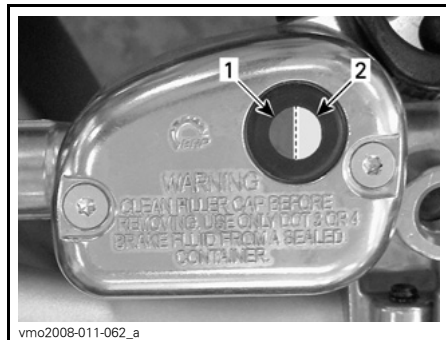
TYYPILLINEN 1. Riittävä nesteen määrä 2. Vähäinen nesteen määrä
