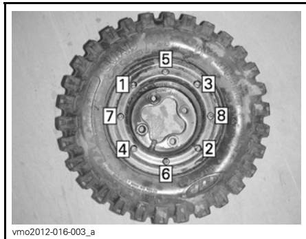
8 PULTIN BEADLOCK-VANTEET — ENSIMMÄISEN JA TOISEN VAIHEEN KIRISTYSJÄRJESTYS
