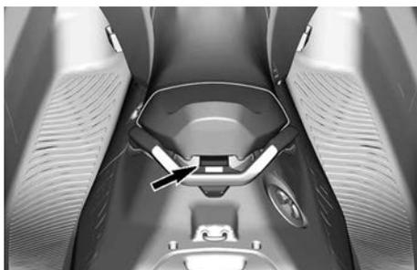
A remoção do assento fornece acesso ao extintor de incêndio (não fornecido com o veículo) e à tampa do tanque de combustível.
