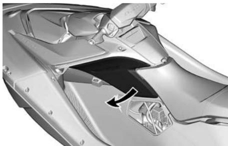
4. Remova a porca, parafuso e arruela para desconectar a barra da coluna de direção.
