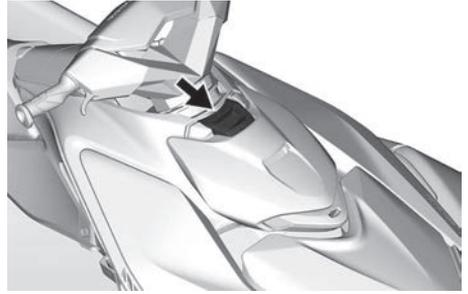
4. Assicurarsi che la linguetta anteriore sia ancorata nella scanalatura della console anteriore.
