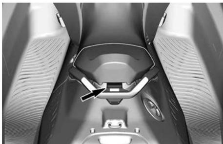
Rimuovendo il sedile è possibile accedere all'estintore (non fornito con il veicolo) e al tappo del serbatoio.
