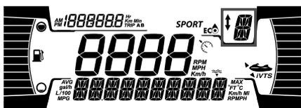
Esta pantalla muestra la posición del engranaje del sistema iBR (si está instalado).
