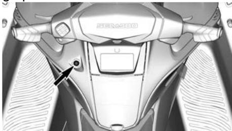
Para que el motor arranque, el tapón del cable de seguridad debe estar instalado correctamente en el interruptor de parada del motor.
