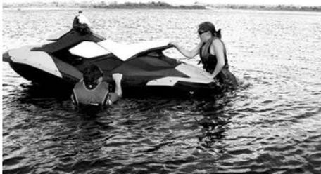
2. Dann klettert der Mitfahrer auf das Fahrzeug, während der Fahrer das Gleichgewicht hält, indem er sich möglichst nah an die Konsole setzt.
