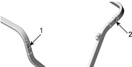
TORNILLOS MEDIOS Y POSTERIORES DE LA ESTRUCTURA DEL TOLDO BIMINI — LADO IZQUIERDO (LH)
