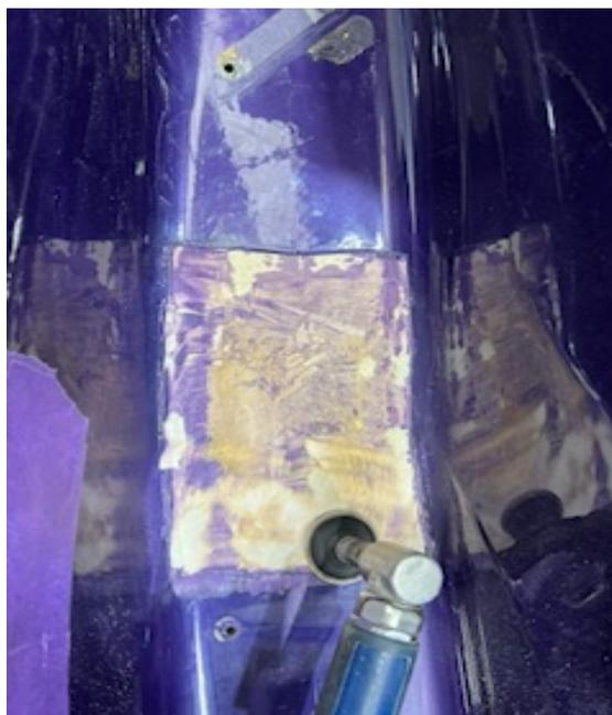
1. Acesse a área danificada, se for possível realizar o reparo sem um remendo de substituição. Em seguida, lixe a área danificada com uma esmerilhadeira pneumática ou lixadeira orbital usando grão 24.
