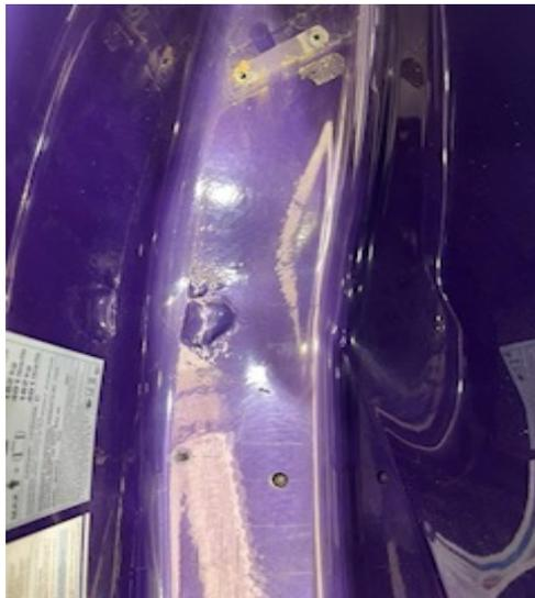
Se o dano for apenas uma pequena rachadura, lixe a área usando uma lixadeira de grão 24 ou uma lixadeira pneumática orbital e aplique massa plástica à base de poliéster Mipa PX9
