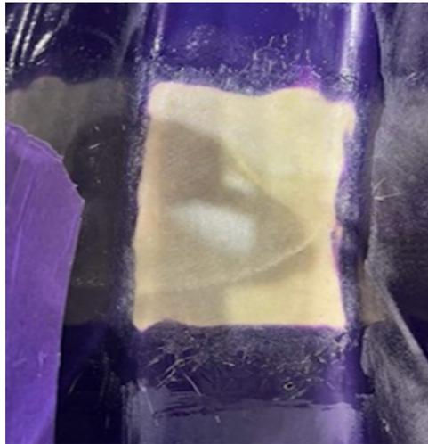
6. Lixe e modele o reparo de fibra de vidro usando uma lixa de grão 80 até obter a forma correta.
