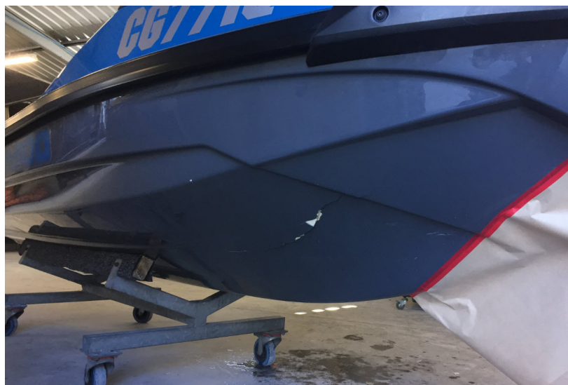
ひび割れの例
