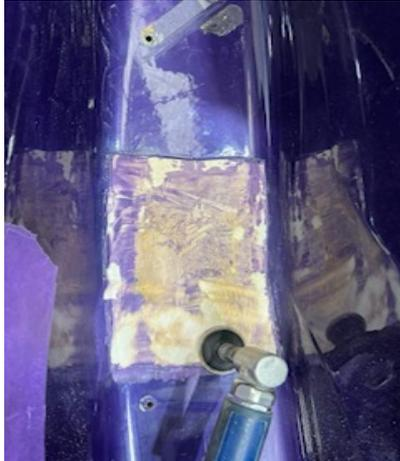
1. Acceda al área dañada y si se puede reparar sin necesidad de un parche de reemplazo, pula la zona estropeada utilizando una amoladora neumática o un esmerilador orbital, con papel de lija de grano 24.
