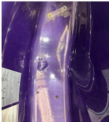
Si el daño incluye solo una pequeña grieta, esmerile el área utilizando una amoladora de grano 24 o una amoladora orbital neumática, y luego aplique la masilla estándar para carrocerías Mipa PX9 hecha de poliéster.
