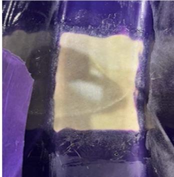
6. Esmerile y dé forma a la reparación con fibra de vidrio hasta que tenga la forma correcta, utilizando papel de lija de grano 80.
