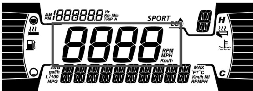
Visualizza il numero di giri del motore o la velocità del veicolo in KM/h o in MPH.
