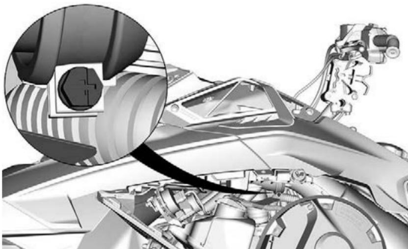
9. Rimuovere le viti che fissano il modulo superiore della carrozzeria su entrambi i lati.
