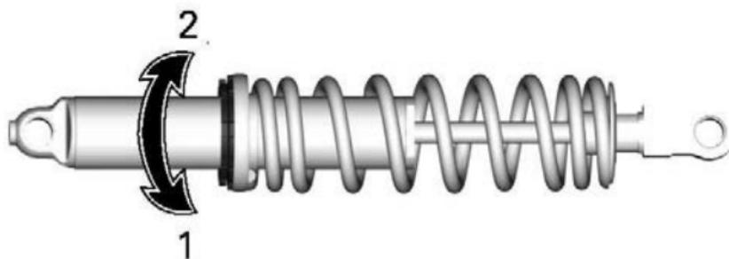
1. Vorspannung erhöhen
