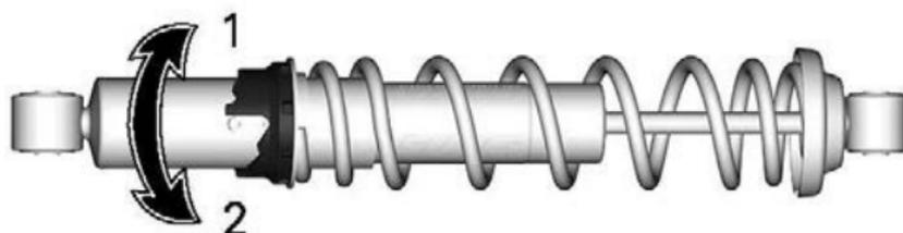
1. Vorspannung erhöhen
