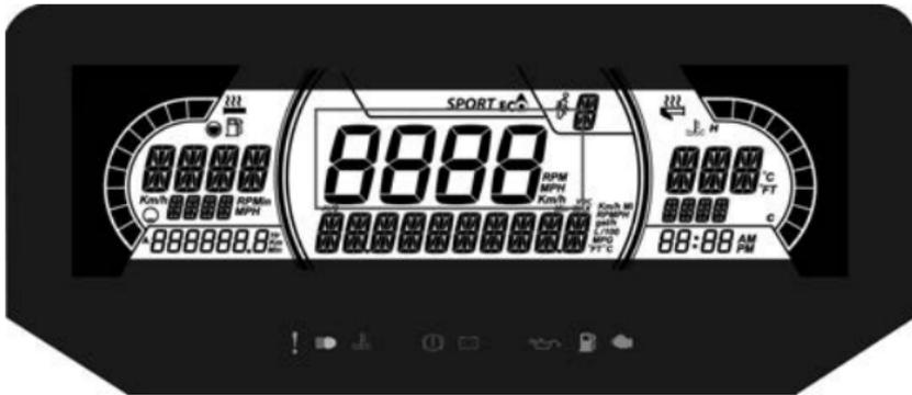
Anzeige der Fahrzeuggeschwindigkeit in km/h (oder mph) oder der Drehzahl in U/min. Siehe *Einstellungen*.
