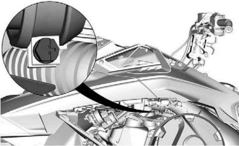
9. Entfernen Sie die Halteschrauben der oberen Karosseriebaugruppe auf beiden Seiten.
