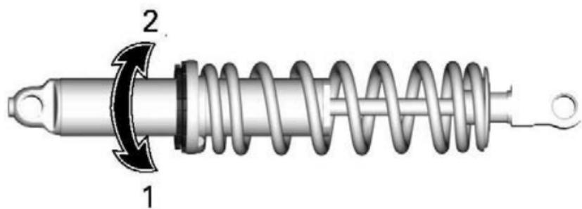
1. Vorspannung erhöhen
