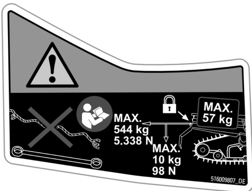
MAXIMALE ZULADUNG UND ZUGLAST – WARNSCHILD
