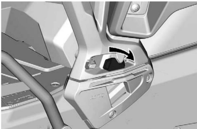
3. Ziehen Sie die Rückenlehne nach oben, um sie zu entfernen.
