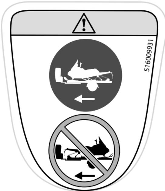
**KORREKTE ABSCHLEPPRICHTUNG – WARNSCHILD**
