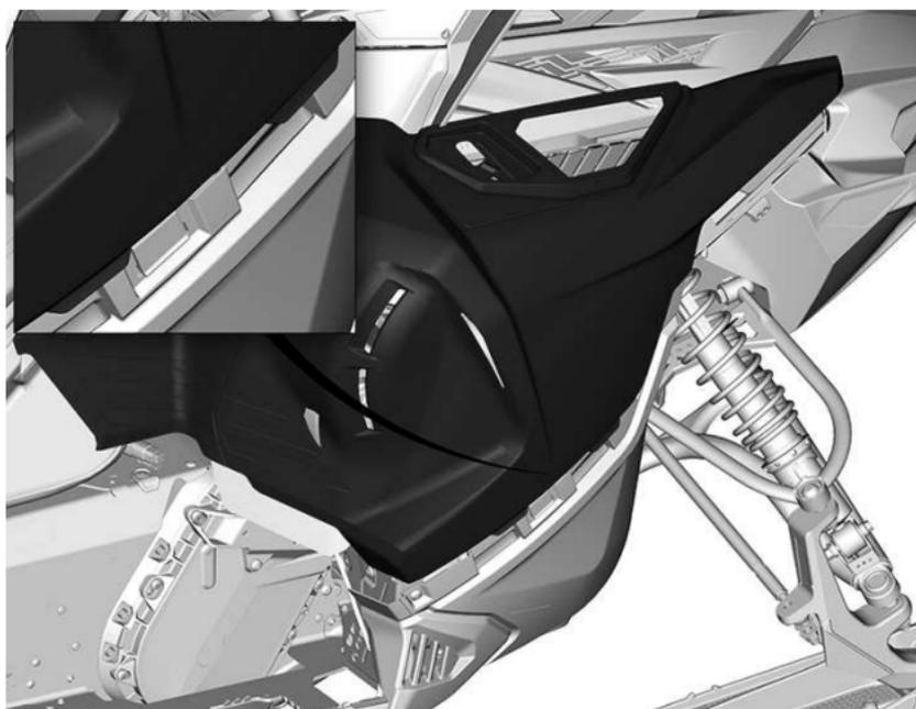
4. Lösen Sie die Seitenverkleidung von der seitlichen Rumpfflasche.
