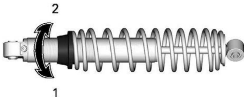
1. Vorspannung erhöhen
