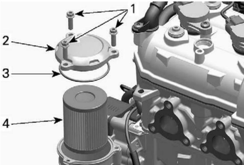
1. Schrauben der Ölfilterabdeckung
