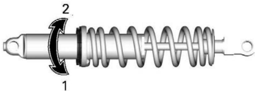
1. Vorspannung erhöhen
