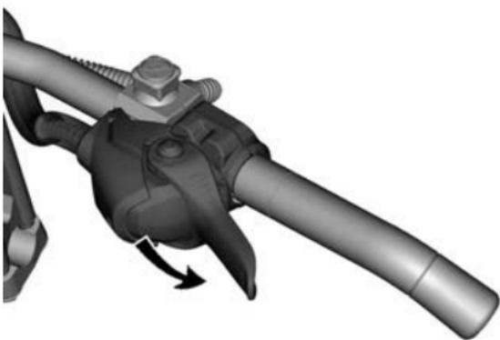
拇指油门杆位置：向下推，使油门杆外壳转动
