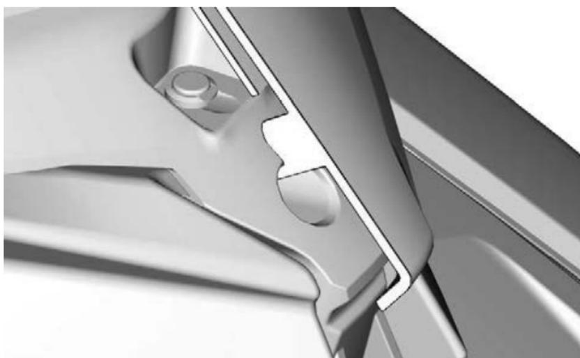
3. 将挡风玻璃销插入橡胶圈，从而固定挡风玻璃。
