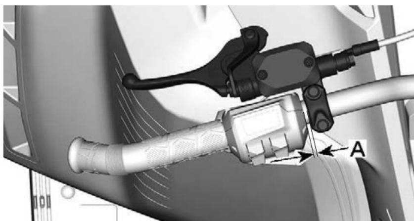
A. 多功能开关侧面与制动杆侧面之间应留出 0 至 15 mm 的距离
