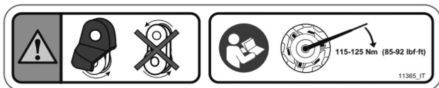
**PROTEZIONE PULEGGIA E COPPIA DI SERRAGGIO PULEGGIA DI TRASMISSIONE – ETICHETTA DI AVVERTENZA E DI AVVISO**
