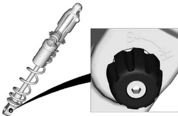
1. Dispositif de réglage de l'amortissement des rebonds
