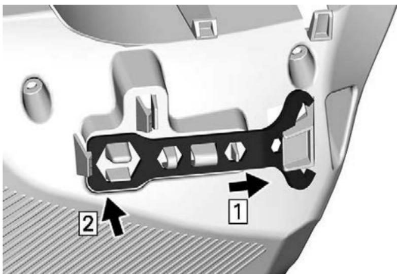
3. Schieben Sie den Scheiben-Expander und die Scheinwerfereinstellvorrichtung am kurzen Ende in das Loch.
