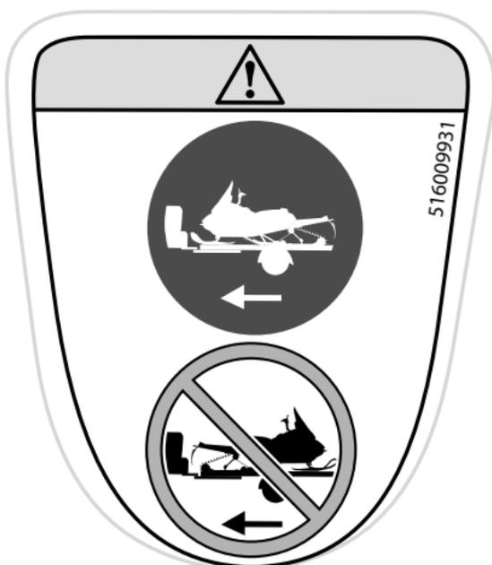
**KORREKTE ABSCHLEPPRICHTUNG – WARNSCHILD**
