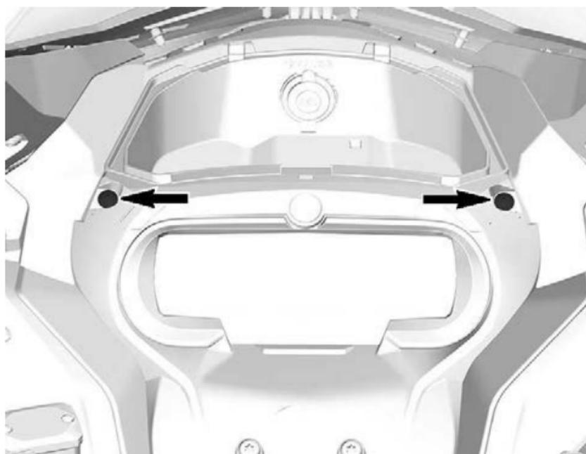
4. Heben Sie die Vorderseite der Anzeigeeinstrumenthalterung an und schieben Sie diese anschließend nach vorne, um sie abzunehmen.
