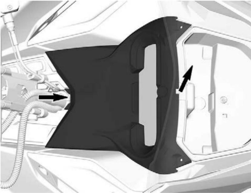
5. Klemmen Sie den Steckverbinder des Anzeigeinstruments ab und entfernen Sie die Halterung.
