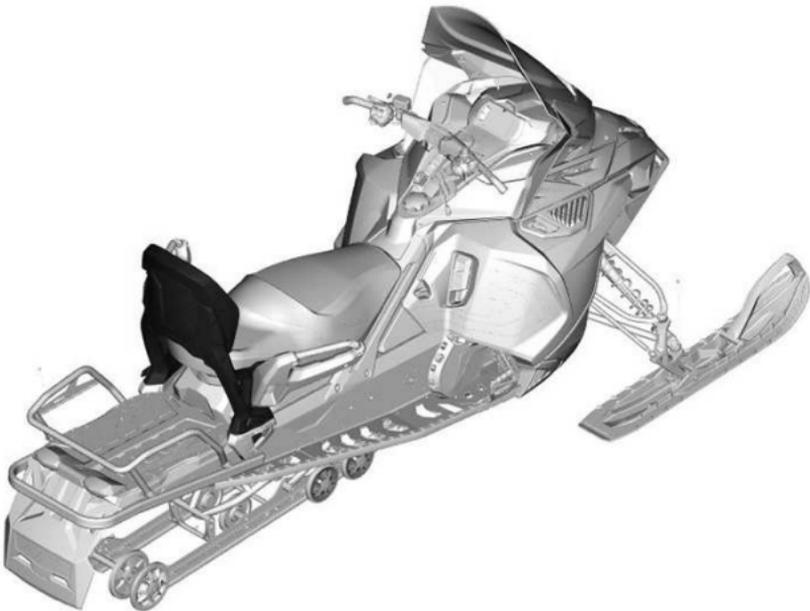
Zum Ausbauen der Rückenlehne entfernen Sie die LinQ-Abdeckung, drehen Sie den Griff und ziehen Sie die Rückenlehne hoch.
