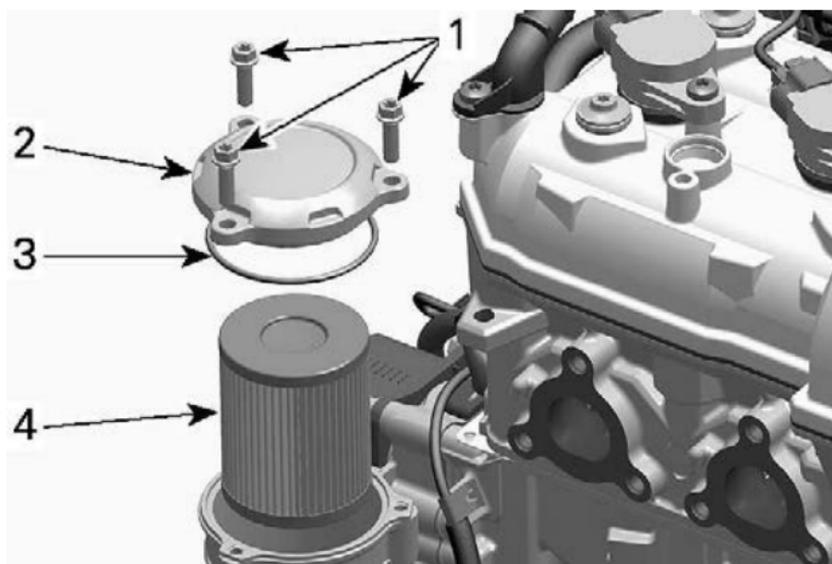
1. Schrauben der Ölfilterabdeckung
