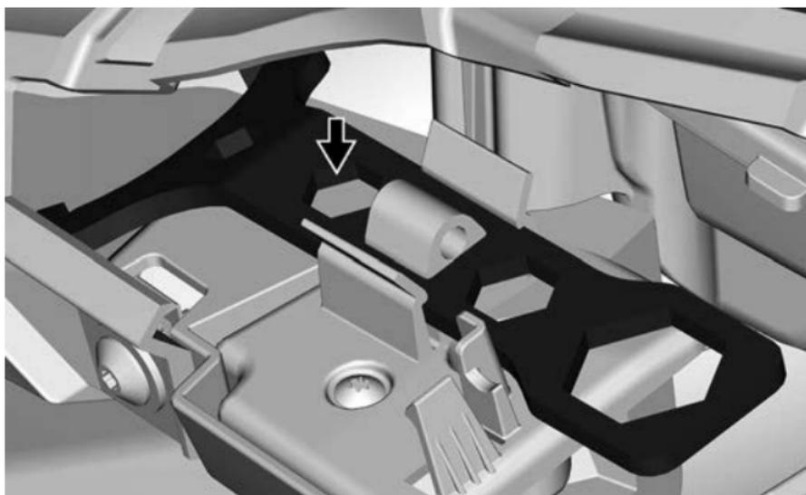
2. Far scorrere il dispositivo di espansione della puleggia e l'estremità lungo dello strumento di regolazione fari nel foro.
