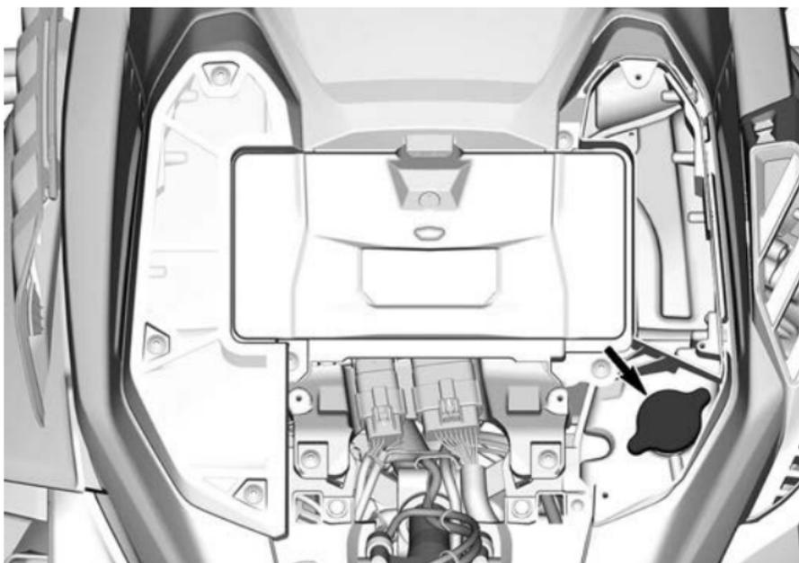
6. Se il livello del liquido refrigerante continua a diminuire durante o dopo ogni corsa, o se è necessario rabboccare l'intero impianto, rivolgersi a un concessionario autorizzato di motoslitte BRP, a un'officina o a un professionista di fiducia per la manutenzione.
