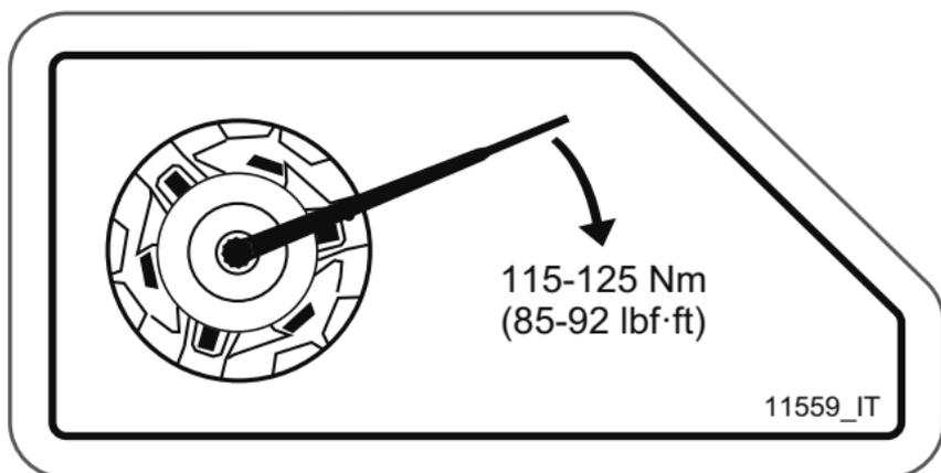
**COPPIA DI SERRAGGIO PULEGGIA DI TRASMISSIONE - ETICHETTA DI AVVISO**
