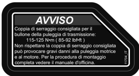
**COPPIA DI SERRAGGIO PULEGGIA DI TRASMISSIONE – ETICHETTA DI AVVISO**
