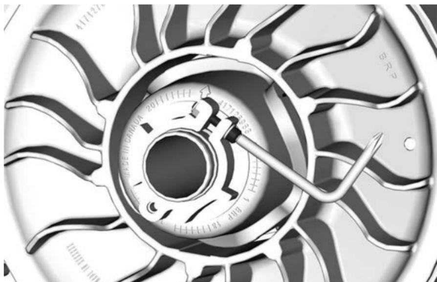
2. Utilizzando lo strumento di regolazione delle sospensioni in dotazione, girare l'anello di 1/4 di giro alla volta, quindi girare la puleggia condotta per installare correttamente la cinghia tra le gole della puleggia.
