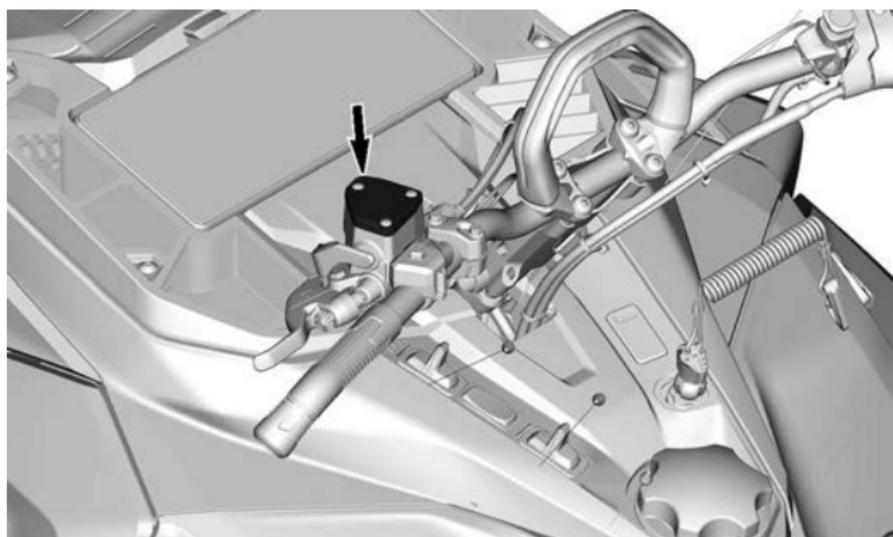
2. Rimuovere le viti di bloccaggio del tappo del serbatoio.
