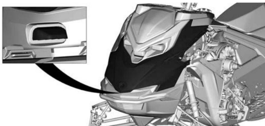
2. Abbassare l'estremità posteriore del modulo superiore della carrozzeria.
