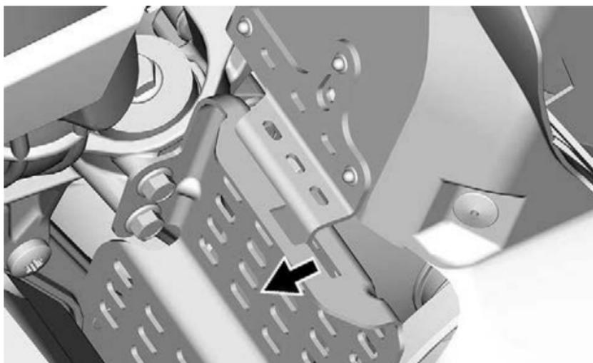
Placez la partie arrière du protège-courroie sur le dispositif de retenue et fixez-le à l'aide de la goupille.
