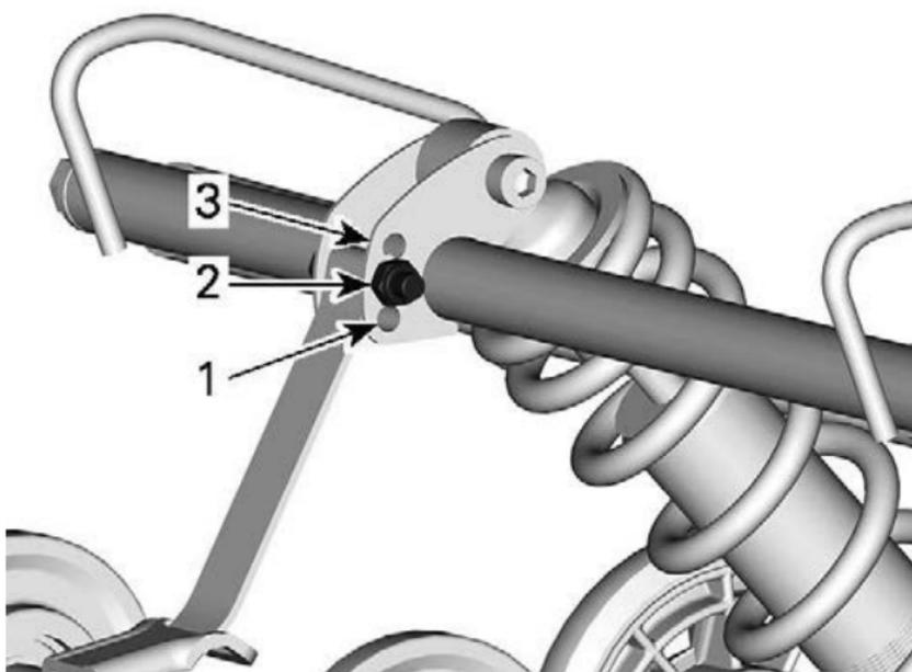
**POSITIONS DE LA COURROIE D'ARRÊT**
