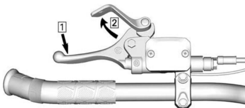
**TYPIQUE — ENGAGER LE MÉCANISME**
