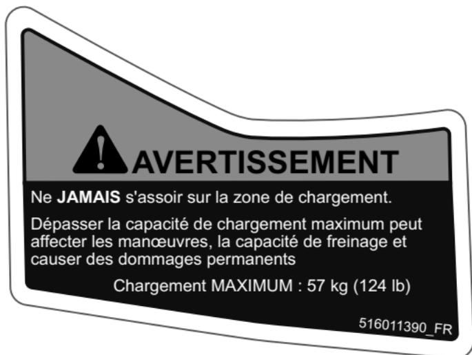
**CAPACITÉ DE CHARGE MAXIMALE - ÉTIQUETTE D'AVERTISSEMENT**
