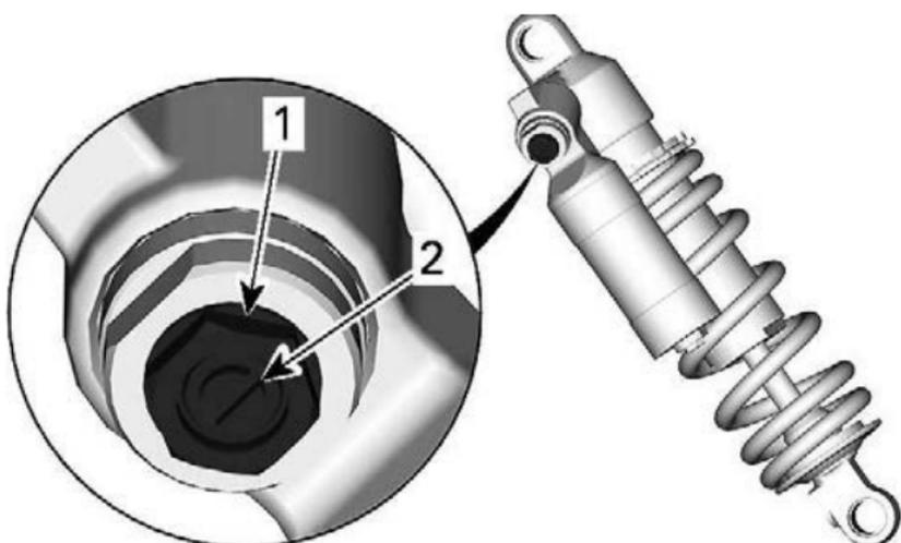
1. Dispositif de réglage de la compression à haute vitesse (hexagonal)
