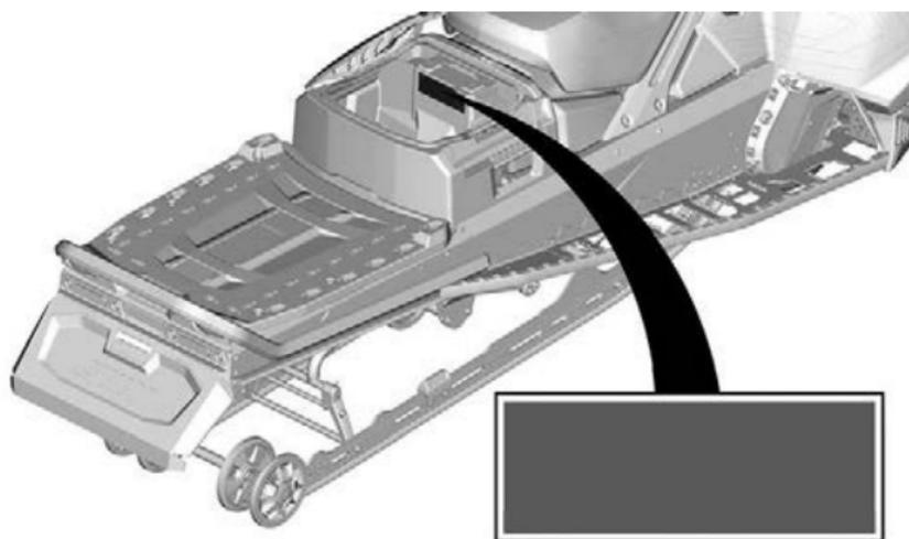
**Capacité de charge maximale - Étiquette d'avertissement**
