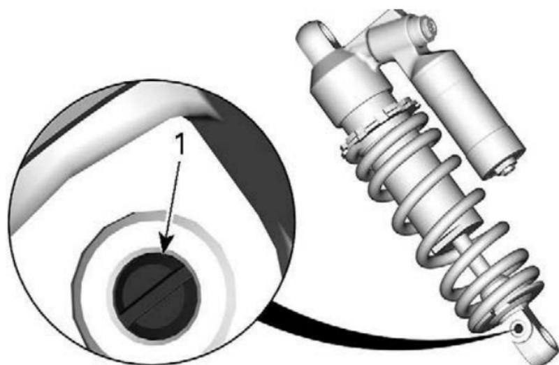
1. Dispositif de réglage de l'amortissement des rebonds
