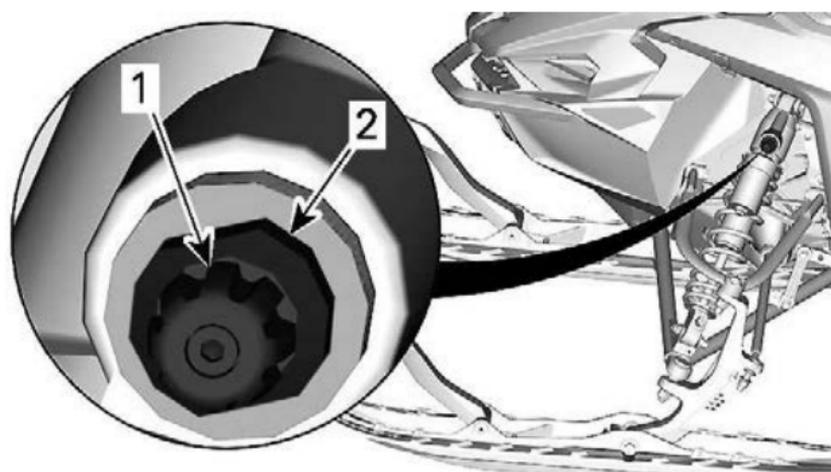
1. Dispositif de réglage de la compression à basse vitesse (bouton)
