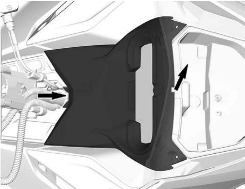
5. Klemmen Sie den Steckverbinder des Anzeigeelements ab und entfernen Sie die Halterung.
