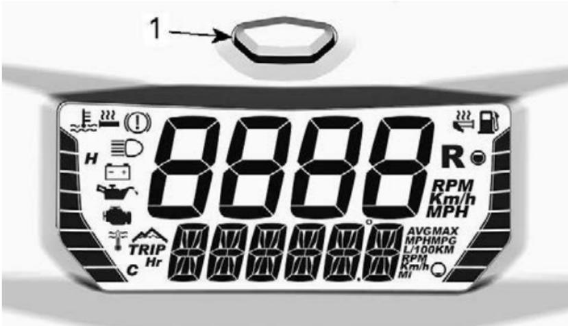
1. Modus-Taste des Anzeigeinstruments
