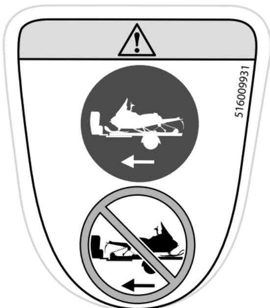
**KORREKTE ABSCHLEPPRICHTUNG – WARNSCHILD**
