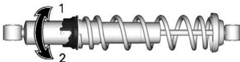
1. *Vorspannung erhöhen*
