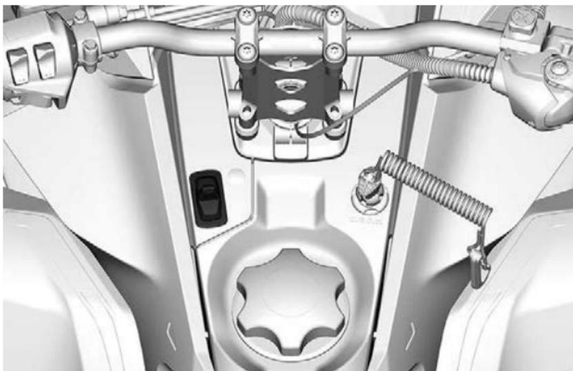
Per attivare la modalità Standard quando ci si trova in modalità Sport, premere una volta la parte inferiore dell'interruttore.
