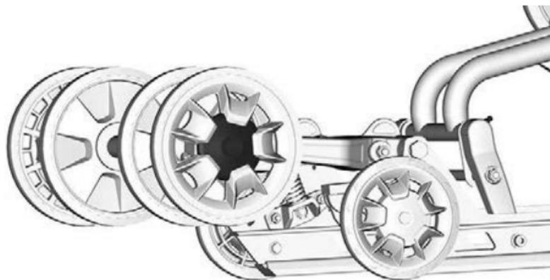
5. Allentare le viti di fissaggio delle ruote tendicingolo posteriori.
