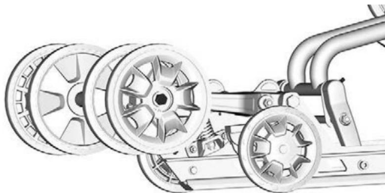
6. Serrare o allentare entrambi le viti di regolazione per aumentare o serrare la tensione del cingolo.
