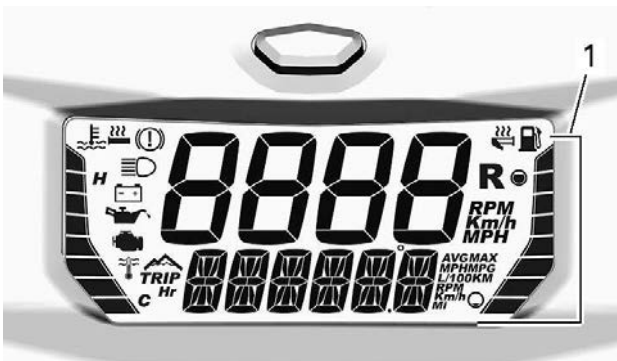
1. Søylemåler høyre side
