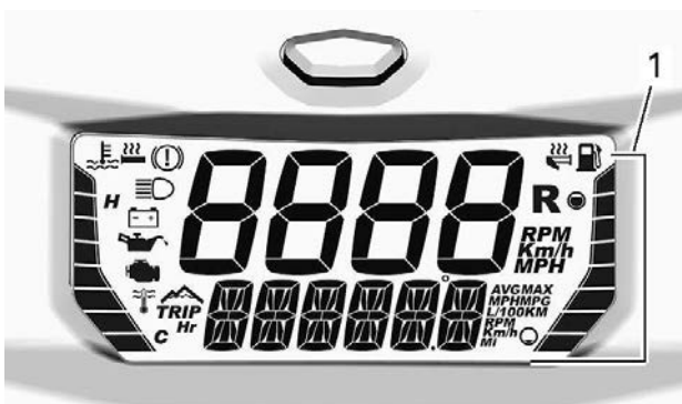
1. Søylemåler høyre side
