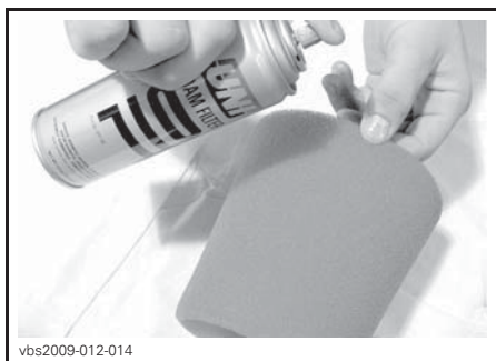
TYPISCH - FILTERELEMENT MET OLIE SMEREN
