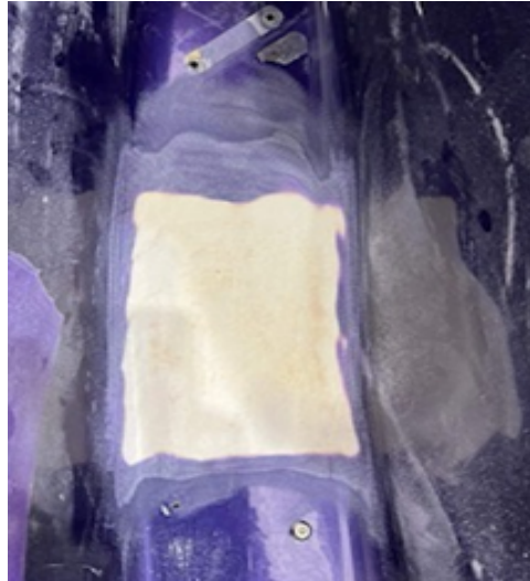
待艇体填料 P118 干燥硬化
