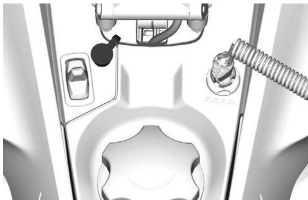
ドライバー側の電動バイザージャックコネクターの位置
