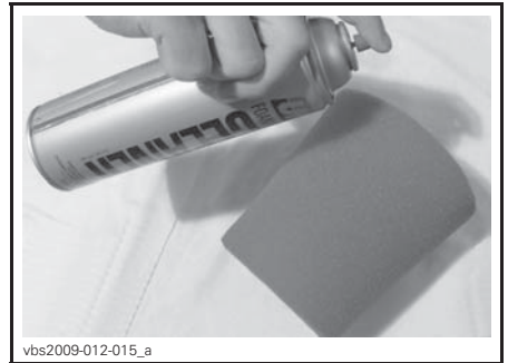
TYPISCH - SCHAUMSTOFFELEMENT INNEN UND AUSSEN BESPRÜHEN
